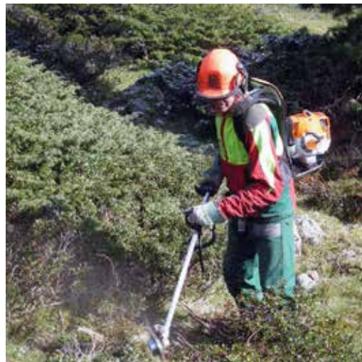
Der Freischneider eignet sich vor allem zum Schwenden von Zwergsträuchern wie Alpenrosen und Heidelbeeren.
